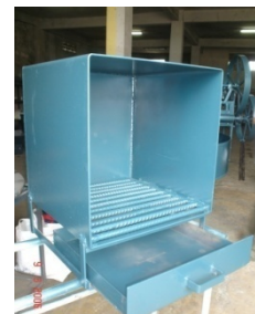
Fig.6 Protótipo do queimador (câmara de combustão) em chapa de aço 1020 e espessura 3/16
